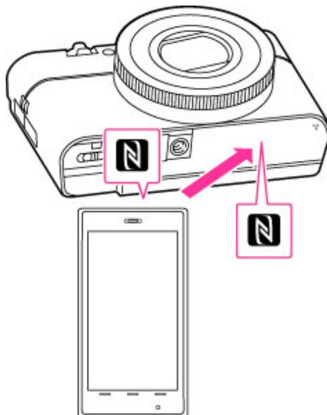
Le smartphone est connecté à l'appareil photo et « PlayMemories Mobile » est activé. L'image actuellement affichée sur l'appareil est transférée vers le smartphone.
