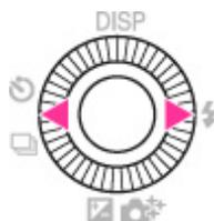
3. Sélectionnez le paramètre souhaité avec ▲ / ▼ ou en tournant la molette de commande, puis en appuyant sur ●.
