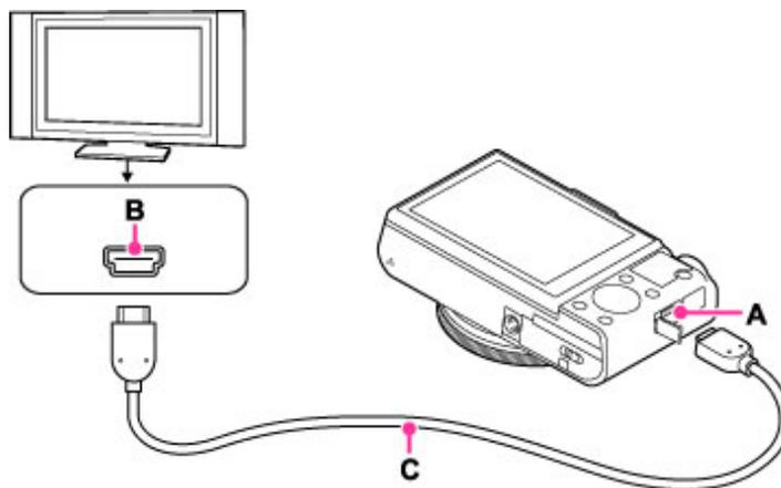
3. Mettez le téléviseur sous tension et réglez l'entrée.
